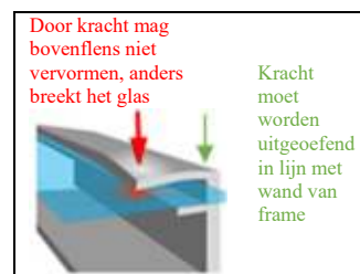
Afbeelding 1a: Locaties voor klemkracht
