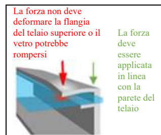
Fig. 1a: posizioni dei morsetti di serraggio
